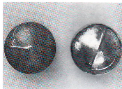
Bovenzijde kogels. Links een loden kogel, rechts een kogel gegoten uit bismut. Bismut blinkt niet alleen sterker, maar krijgt na enige tijd een licht-gele kleur.
