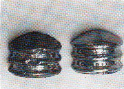
Zij-aanzicht kogels. Links loden kogel, rechts kogel gegoten uit het metaal bismut.
