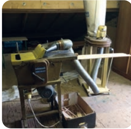
De van diktebank met spaanafzuiger voor de stokjes.
